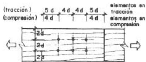
Fig. 10.3.3.a Espaciamientos mínimos entre pernos, cargas paralelas al grano.
