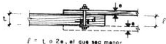
Fig. 10.3.2.5 Unión emperrada sometida a cizallamiento simple
