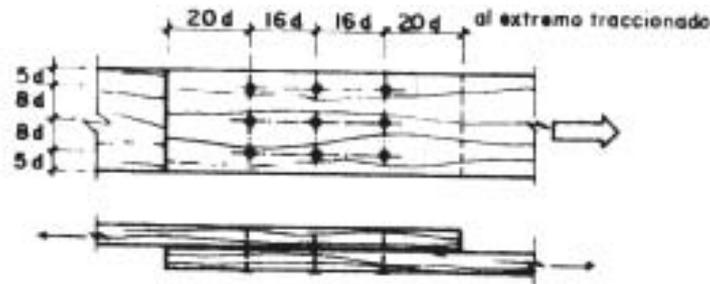
Fig. 10.2.5.2a. Elementos cargados paralelamente al grano.
