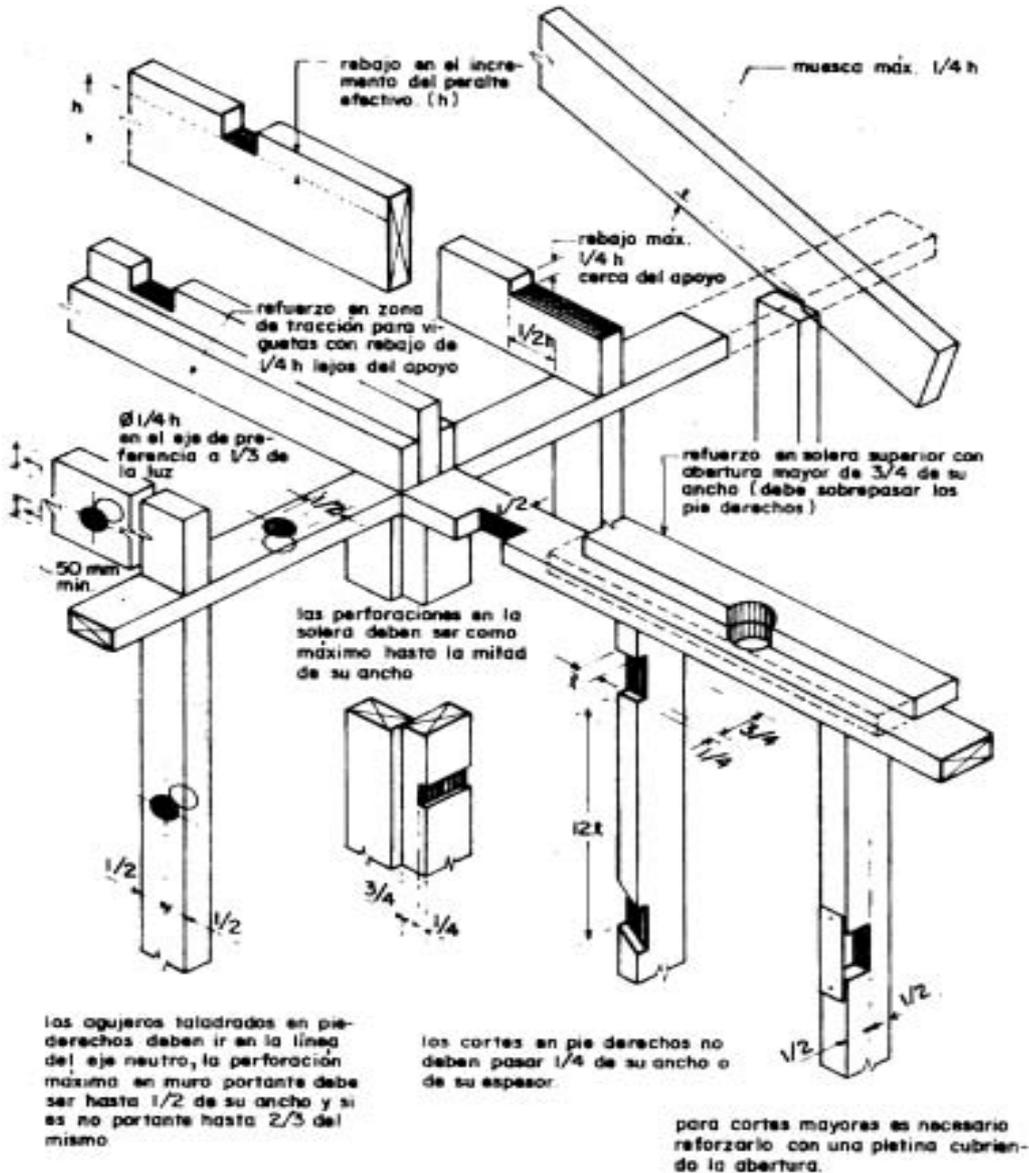
Fig. 12.2.2 Perforaciones y rebajos en elementos de madera.
