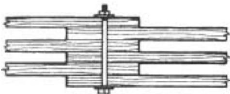
Fig. 10.3.2.6. Unión empernada sometida a cizallamiento múltiple
