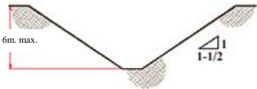
TALUD SIMPLE TIPO DE SUELO C
